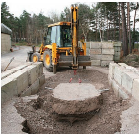
Het uitgraven van TriAx ten behoeve van het schadeonderzoek bij het TRL.
