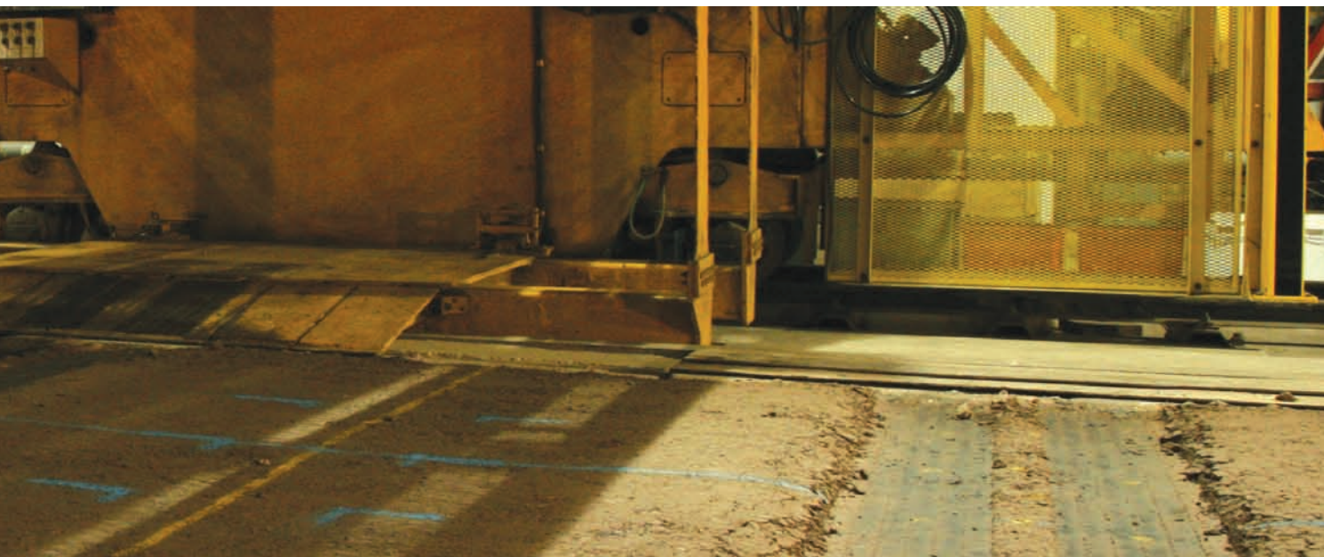
Verkeersproeven bij het TRL leverden het bewijs voor de betere werking van TriAx geogrids in vergelijking met biaxiale geogrids.
